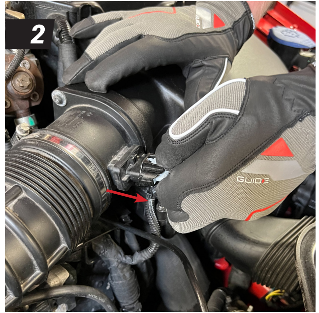
2 Lossa kontakten på luftmassemätaren.
