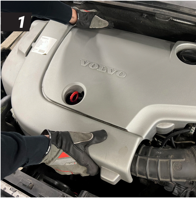
1 Demontera motorkåpan genom att dra uppåt.
